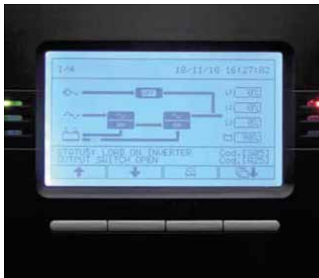
Grafik-Display (240 x 128 Pixel m. Beleuchtung)
